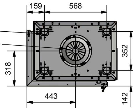
Alle Höhenangaben gelten bei einer Mörtelfugenstärke von 3 mm, einer Fasermattenstärke von 3 mm (im zusammengepressten Zustand) und vollständig nach unten geschraubtem Grundgestell.
